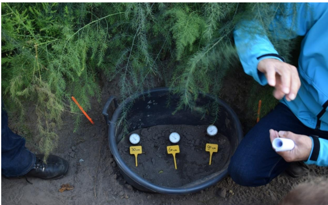
Figur 9. Demonstration av tensiometrar. De ger ett värde på hur mycket vatten som finns växttillgängligt i profilen. En tensiometer mäter undertrycket på olika djup, och värdena tolkas utifrån olika kurvor för olika jordtyper. Bild: Victoria Tönnerberg
