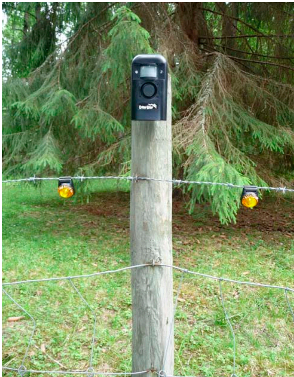
"Crittter Gitter" monteras så att djurets rörelser kan registreras och aktivera ljudskrämmen. Ljusstarka lampor kan placeras ut längs stängslet.
