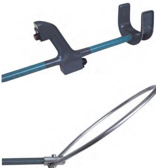
Figur 6.9. Elfiskestav av märket Hans-Grassl – här ses den övre delen med handtaget och den nedre delen med den strömförande ringen. Staven fungerar bra att använda i större vattendrag men är svårare att manövrera i mindre vattendrag. För att göra det lättare att använda staven i mindre vattendrag kan man korta av skänklarna på den u-formade delen.
