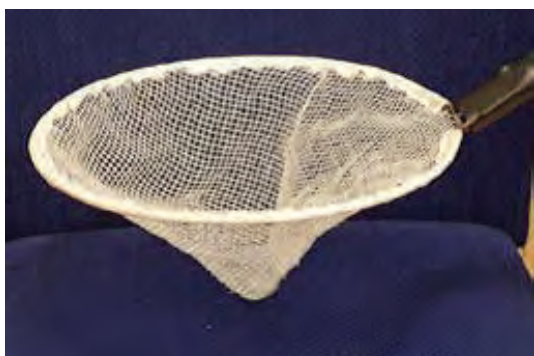
Figur 6.16. Håv med 25 cm diameter och skaft av glasfiber (Foto: Stefan Stridsman)
