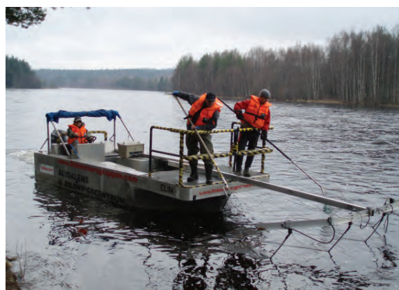
Figur 1.2. Båtelvfiske i större vattendrag och sjöar. Två personer håvar fisk som lockas till anoden längst fram. Foto: Erik Degerman.
