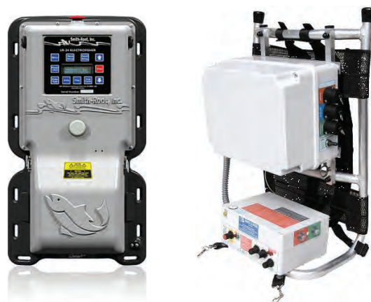
Figur 6.7. Batteriaggregat av märket Smith-Root LR 24 (till vänster) och Hans-Grassl IG200 (till höger). Båda har lutningsbrytare som bryter strömmen när aggregatet lutar mer än 45°.
