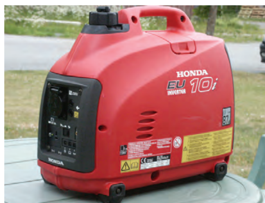
Figur 6.2 Elverk Honda EU10i som kontinuerligt genererar 900 W (maxeffekt 1000 W) och väger 13 kg.
