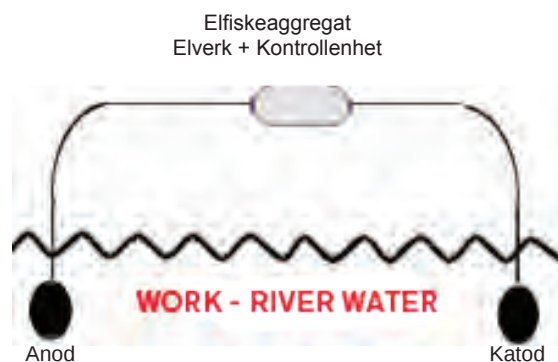
Figur 4.6. Principskiss av huvudströmkretsen vid elfiske (modifierat från Anon. 2007).
