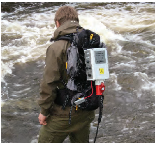
Figur 6.6. Batterielekfiskeaggregat av märket Geomga FA 4. Aggregatet bärs på ryggen under elfiske och är därför försedd med en lutningsbrytare. Jordfläten (ej med på bilden) släpar efter elfiskaren i vattnet.
