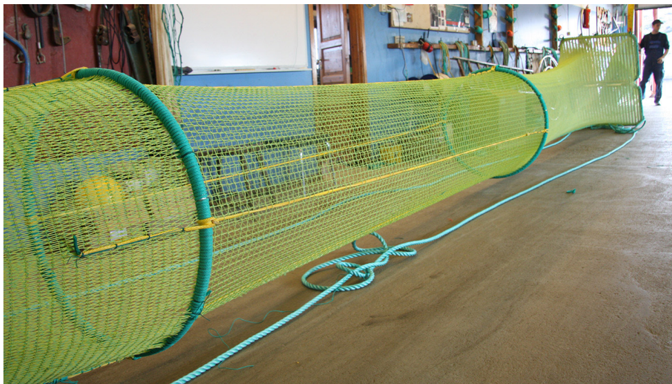
Figur 1.1.2 Del av lyft med ringar monterade för att ställa fyrkantsmaskan.
