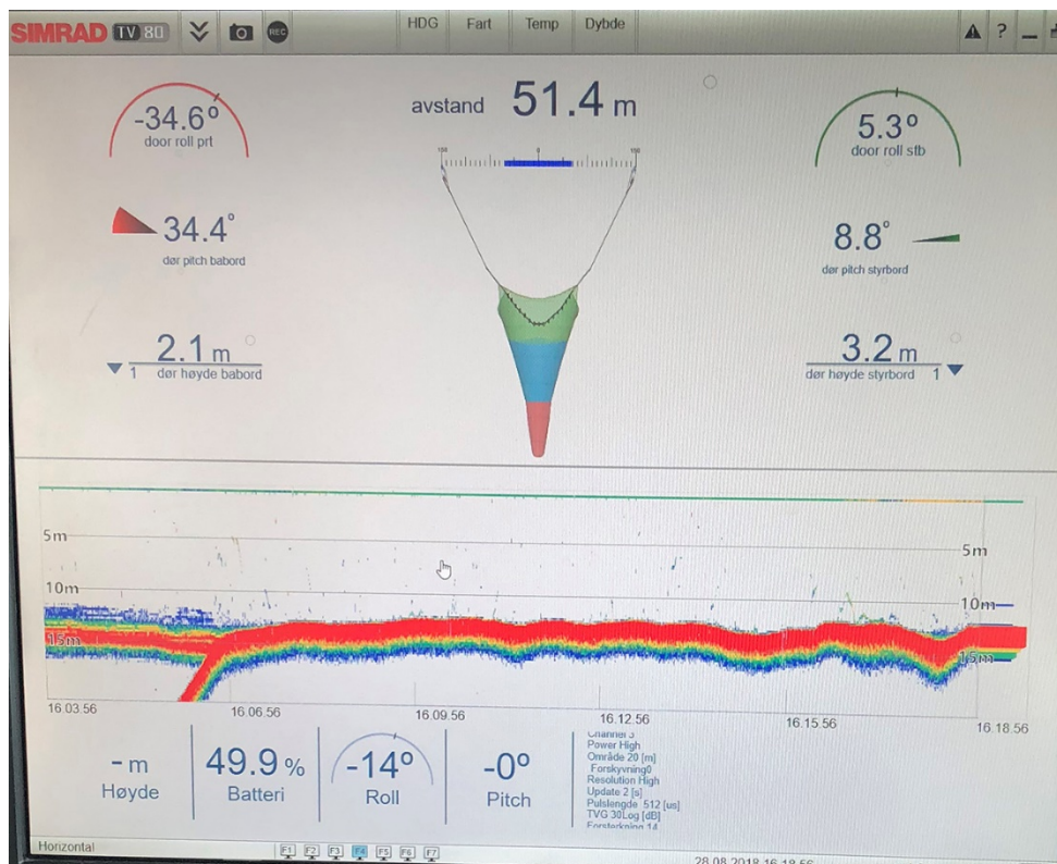
Figur 2.5 Bild av gränssnittet (enkeltrål) för trålsensorer, visandes trålbordens, spridning, lutning (roll och tilt) och höjd ovanför botten, samt trålenshöjd. I ekogrammet till vänster ses först endast underteln som sedan möter botten under sättningen av trålen. Under sättningen av trålen sjunker fiskögat mot botten, vilket gör att det i ekogrammet ser ut som att det grundar upp, men i detta exempel är botten-djupet ungefär detsamma i hela diagrammet.
