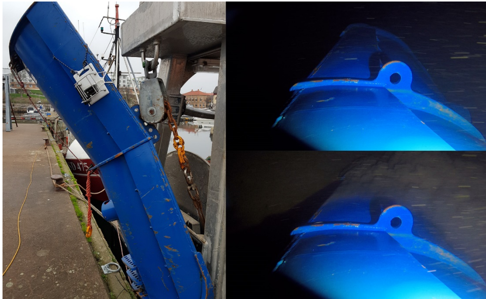
Figur 2.9. Till vänster: kamerans läge på trålbordet. Till höger: kamerans vy när trålbordet går i vattenmassan (högst upp) och i botten (längst ner).
