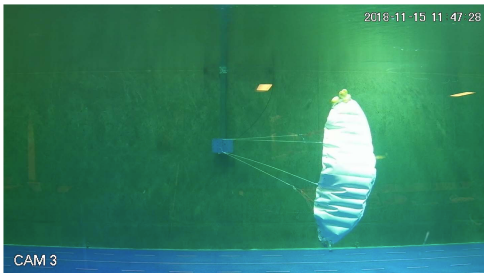
Figur 3.2. Bild tagen i Hirtshalstanken vid de första försöken. Trålbordens design liknar designen hos den "kitevinge" som var ursprunget till idén om mjuka trålbord. Kiten är fäst via linor till en fästplatta som är monterad på till en lastcell som mäter kraften som genereras av kiten i vattenflödet (se även Figur 3.1).
