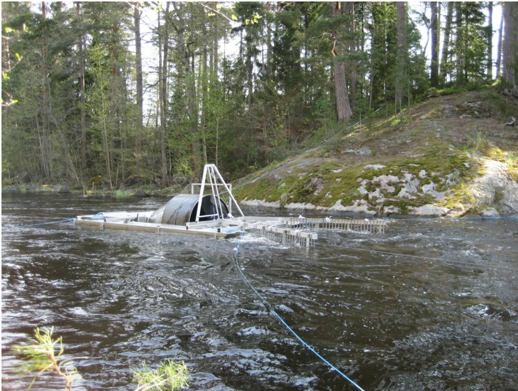
Figur 6. Smolttrumman med ledarmar på platsen med hög strömhastighet.
