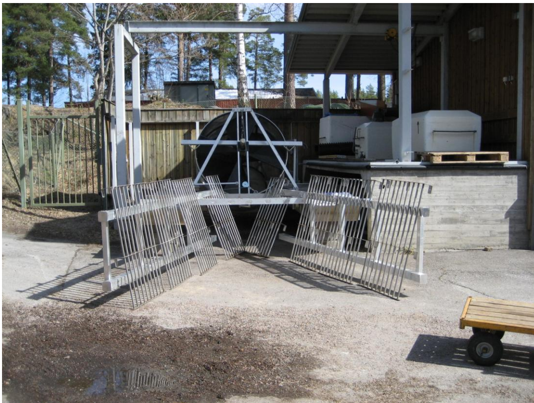
Figur 7. Smolttromma med ledarmar innan den sattes i vattnet. I vattnet var gallren hängda lodräta mot ställningen utan mellanrum. De två innersta gallren längst in mot trumman användes inte vid försöksserien.
