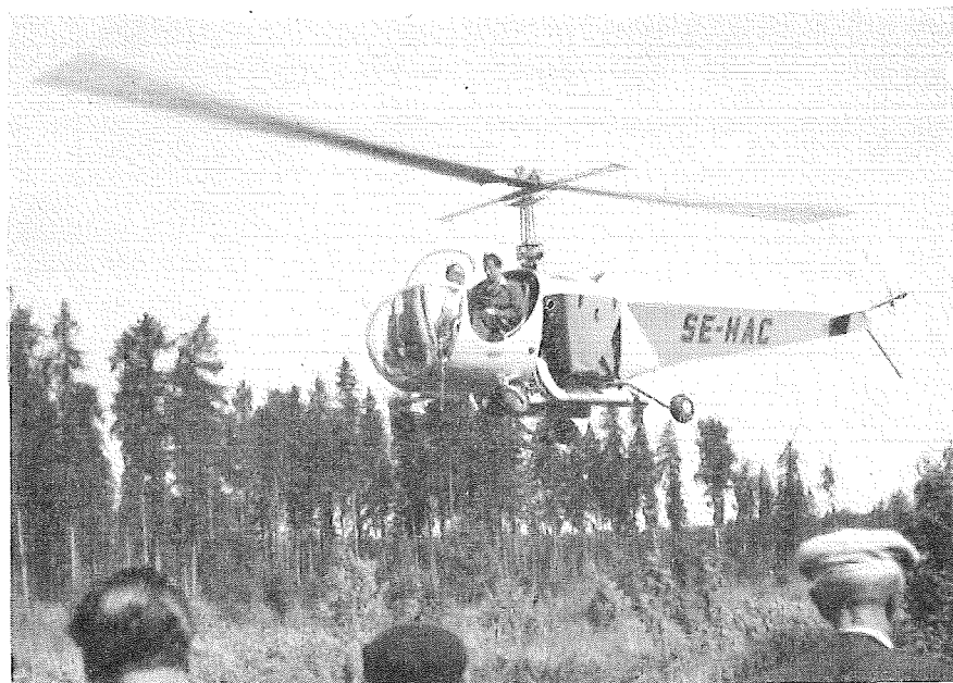
Helikoptern under nedstigning. Under maskinen synes utblåsningsrören för pudret och på sidan den ena puderbehållaren.
