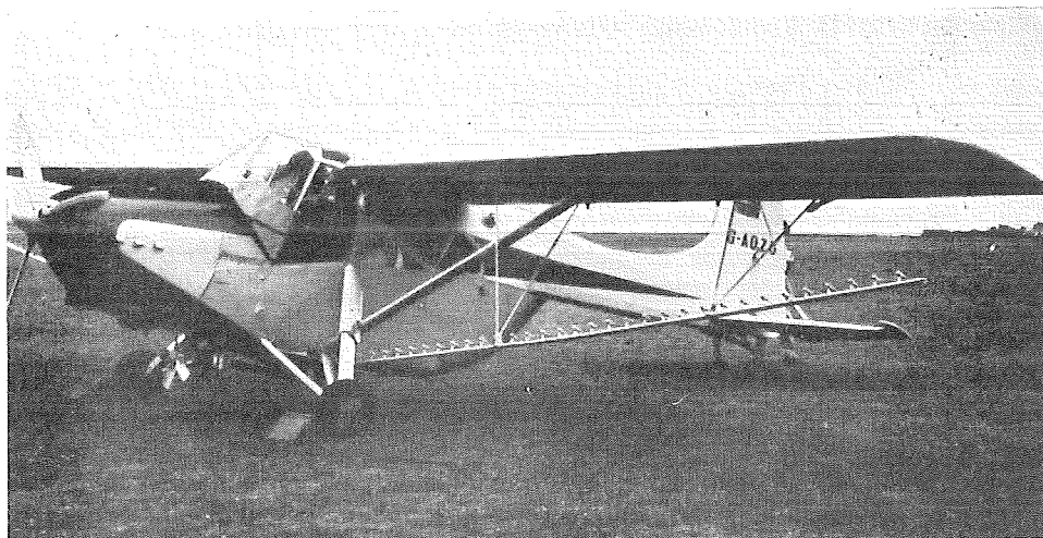
Bilden visar spruttrampens placering på ett flygplan med fasta vingar. Foto A. Stenmark
