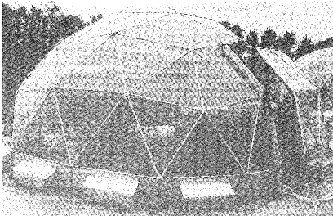
Fig. 3. "Solar-domes", glaskupoler där grödor odlas och exponeras för luftföroreningar under fältliknande förhållanden. — Solar-domes, chambers for growth and exposure of crops to air pollutants under field-like conditions.
