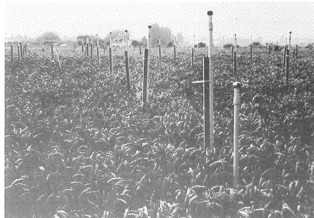
Fig. 2. "Open-air fumigation system" — anläggning för exponering av växter för luftföroreningar i fält vid CERL:s fältstation, Little Hampton. — Open-air fumigation system — a system for exposing plants to air pollutants in the field at CERL's fieldstation, Little Hampton.
