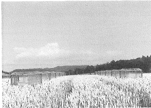
Figur 1. Fältkammarförsök med vårvede vid Östad säteri sommaren 1987. En fältkammare är en typ av taklöst växthus, genom vilken luft pumpas. Kamrarna på bilden är 1,25 m i diameter och 1,6 m höga. – Open-top chamber experiment at Östad säteri in the summer of 1987. An open-top chamber is a type of greenhouse without a roof through which air is forced. The chambers on the picture are 1.25 m in diameter and 1.6 m tall.
