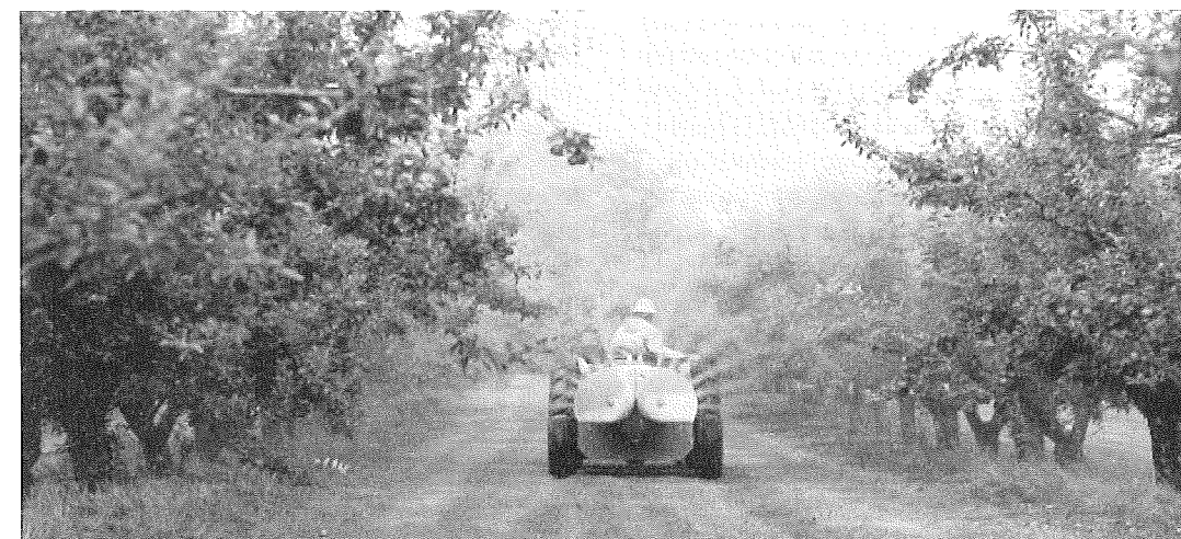
Den traditionella fruktträdssprutan ger en solfjäderformad sprutdusch som till en viss grad går över träden vilket innebär stor risk för vindavdrift - The traditional fruit tree sprayer gives a shower which reaches over the treetops and therefore increases the risk of wind-drift. Foto: Christer Torneus.
