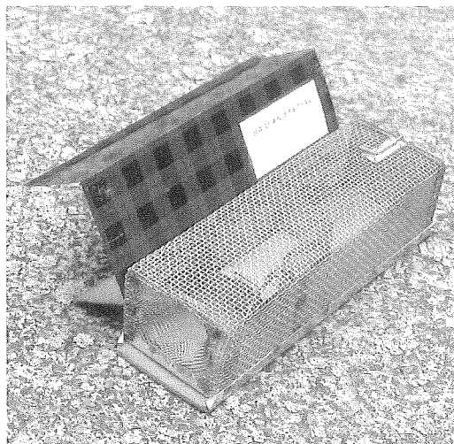
Figur 2. Ugglan Special med lock för utomhusbruk. Fällan betas med havregryn. En bomullstuss fuktad med vatten kan läggas på nätets ovsida. Det är lätt att ta ut de levande djuren genom att trä en plastpåse över bakre delen och öppna luckan. Om djuret ej vill hoppa ut i plastpåsen kan man blåsa från ingångsöppningen. - Ugglan Special with lid for outdoor use. The trap is baited with oatmeal. Cotton moistened with water can be applied to the top of the wire netting. It is easy to remove the live animals by placing a plastic bag over the back part and open the door. If the animal refuses to leave the trap, just blow from the entrance end.
