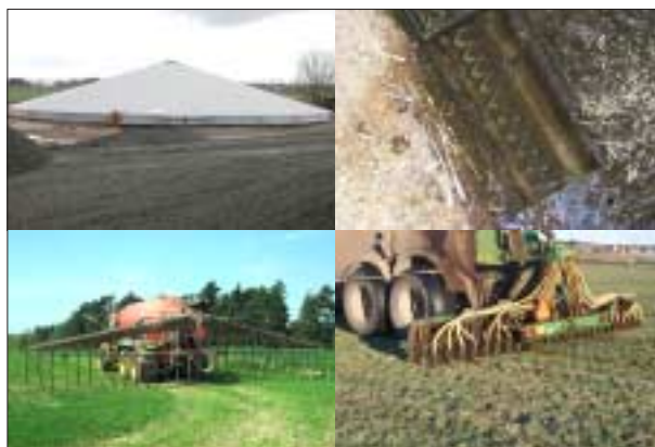
Biofilter för utgående stallluft, kupoltak över gödselbrunn, urinskruv i gödselrännan och flytgödselspridare med ramp respektive myllningsaggregat är exempel på vad som använts inom projektet.
