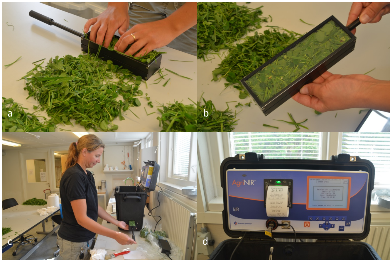
Bild 2. Påfyllning av grönmassa i provlådan (a och b) och analys med hjälp av AgriNIR-instrument (c och d).
