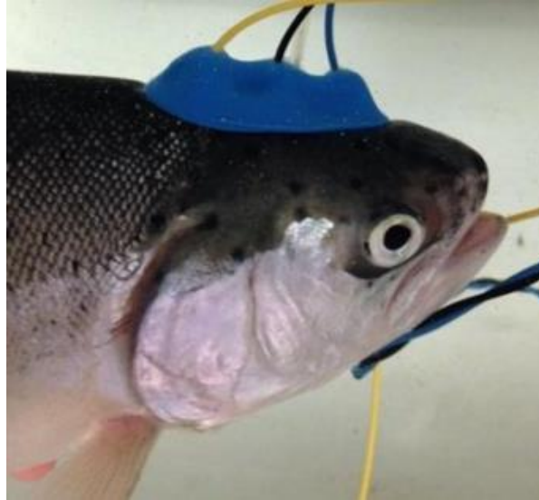
Figur 2. En nyligen utvecklad metod för att mäta EEG på fisk med hjälp av elektroder inrymda i en sugkopp som sugts fast på fiskens huvud.
