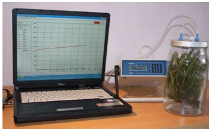
En koldioxidanalysator från PPsystems används här till en hemgjord fotosynteskyvett. Mätvärdena visas samtidigt på en dator.
