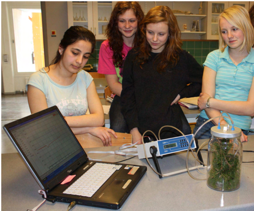
Bild 2. Inomhusmätning av fotosyntes och respiration på en grankvist
