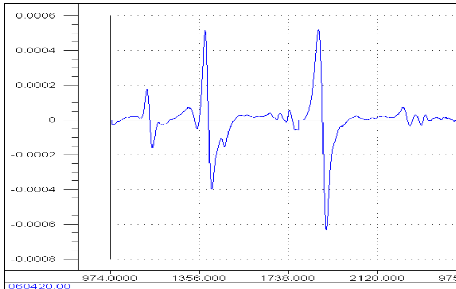
Figur 8. Andra derivatans NIR-spektrum för det dagliga provet den 20 april. På x-axeln står våglängderna i nm.
