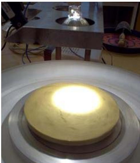
Figur 7. Avläsning av maltat prov med NIR instrument.
