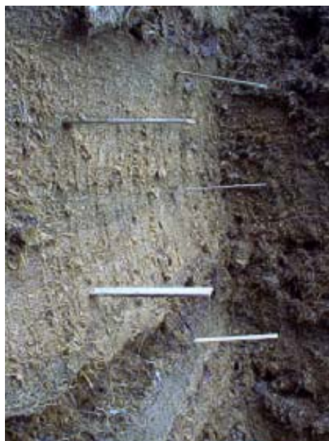
Figur 3. Snittyta från sidan med pinnar som markerar var prover ska tas.
