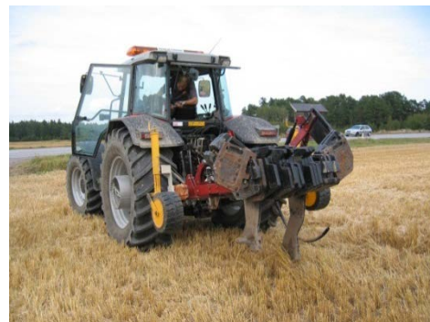
Figur 2. Penetrometerutrustningen i fält.
