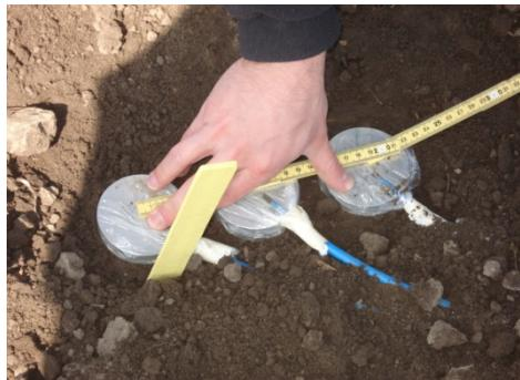
Figur 8. Lastceller för att mäta tryck under traktor och packarhjul.
