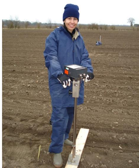
Figur 9. Mätning med penetrometer.
