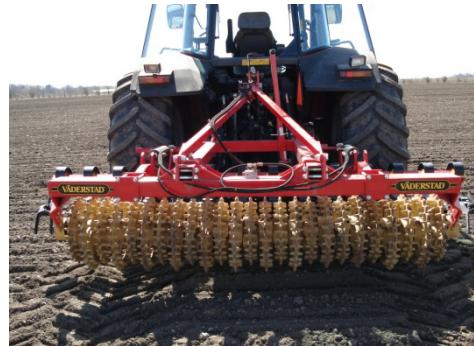
Figur 6. Vält som användes till packning.
