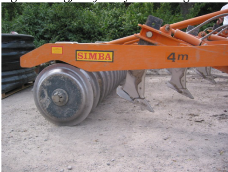
Figur 4. Simba alvluckrare, använd till djupluckring.
