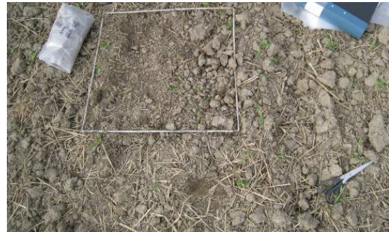
Figur 8. Ram vid provtagning av halm.
