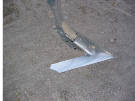
Figur 5. Gåsfootskär på kultivatoren till den ytliga bearbetningen.
