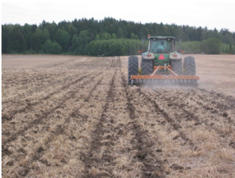
Figur 2. Djupluckring i band hösten 2006.
