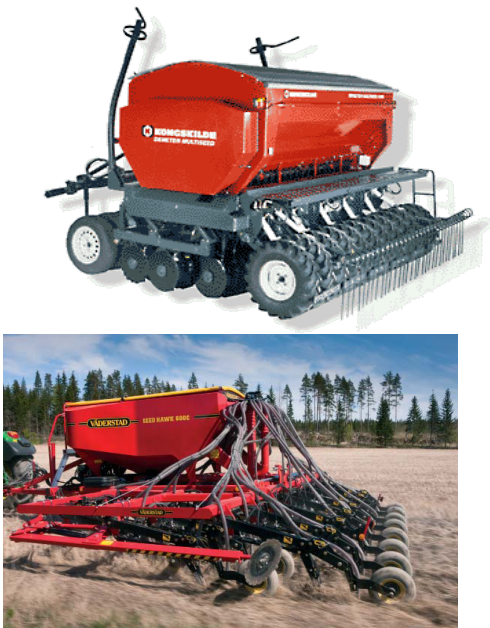
Figur 3. Det finns i dag många såmaskiner på marknaden som kan användas vid direktsådd. På bilden ses överst Kongskildes Demeter Multiseed och underst Väderstads Seed Hawk.
