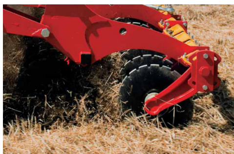
Carrier består av två rader med tandade och koniska tallrikar som aggressivt bearbetar stubben.
