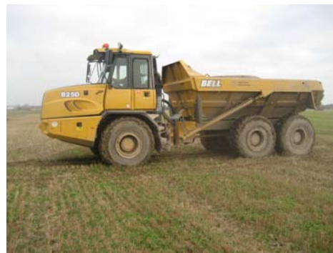
Fig. 22. Packning med dumper.
