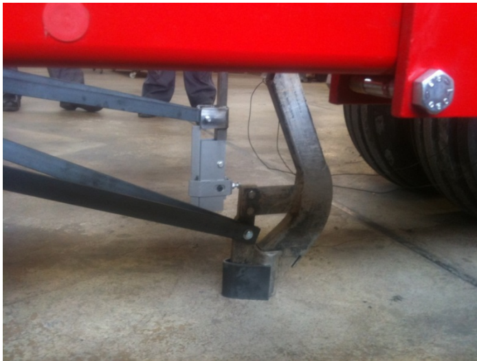
Figur 15. Mätbilar på plattformen. Närmast: bill med inmonterad NIR-sensor. Bakom: såbill för mätning av bearbetningsdjup.
