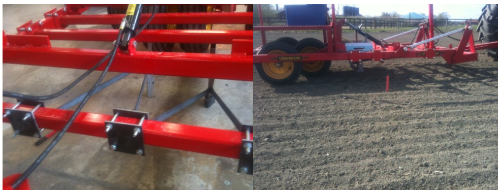
Figur 14. Mätvagn. Till höger vid körning för att bestämma såbäddsegenskaper.
