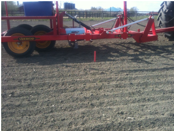
Figur 21. Mätvagn vid körning för att bestämma såbäddsegenskaper.
