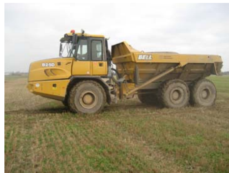
Fig. 30. Packning med dumper.
