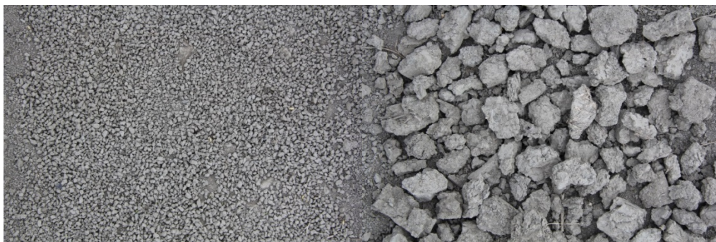
Figur 9. Bilder från mätningar i renfraktioner av aggregat. Digitala bilder av fraktionerna 4-8 och 32-64 mm.
