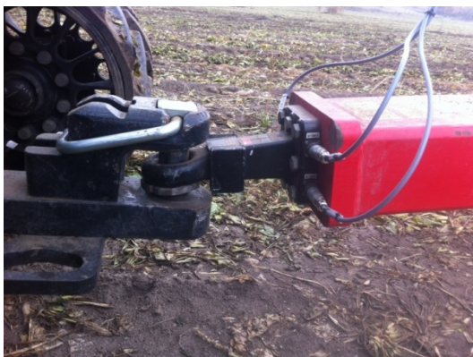
Figur 6. Det specialtillverkade draget med kraftgivare som användes vid försöken.
