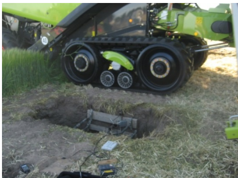
Figur 3. Teknik för mätning av tryck i marken. Sonder finns installerade på olika djup i marken mitt under spåret.
