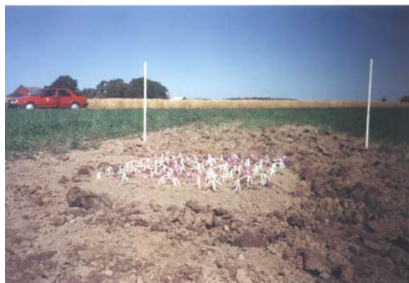
Figur 10. Burkarna ventilerades via "sugrör" genom locket.
