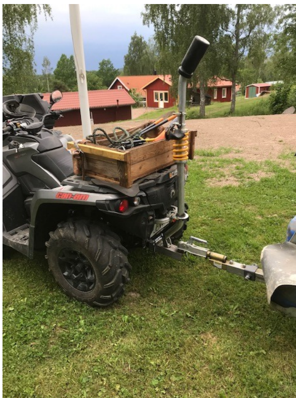
Monterad QuadBar med egenkonstruerat fäste på dragkroksbalken samt upphängningsanordning för röjsåg. Foto: Håkan Johansson
