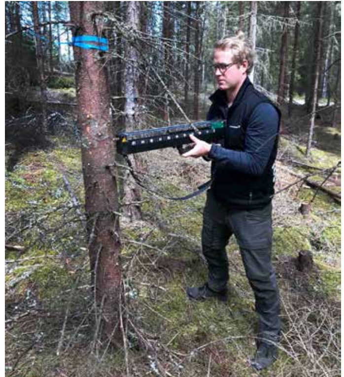
Magnus Persson gör mätningar på gran med resistografen. Foto: privat.
