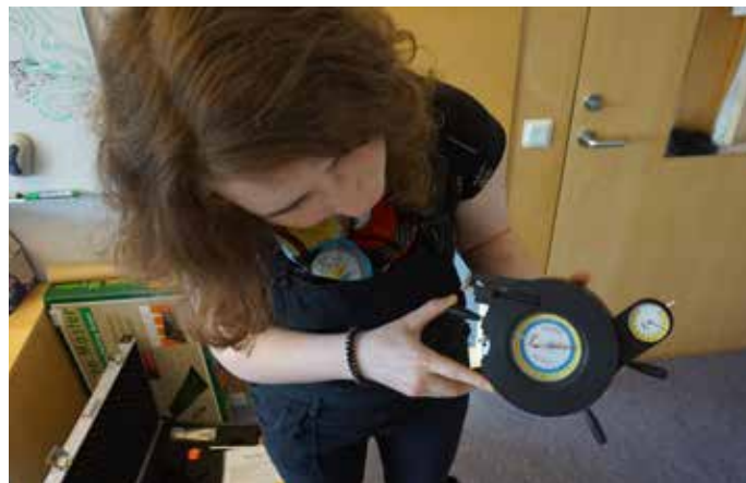
Fractometer för mätning av böjhållfasthet (ovan). Foto: Grace Jones. Grace Jones har laddat borrhärdar från björk för analys i Itrax (vänster). Foto: Joran van Blokland.
