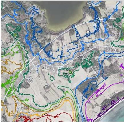
Figur 1. Landhöjningskarta med klintar och kustlinjer för vart 500:e år upp till 4500 år tillbaka skapad utifrån GSD-Höjddata, grid 2+ © Lantmäteriet. Bakgrundsbild: GSD-Ortofoto, 1m färg © Lantmäteriet (2014).
